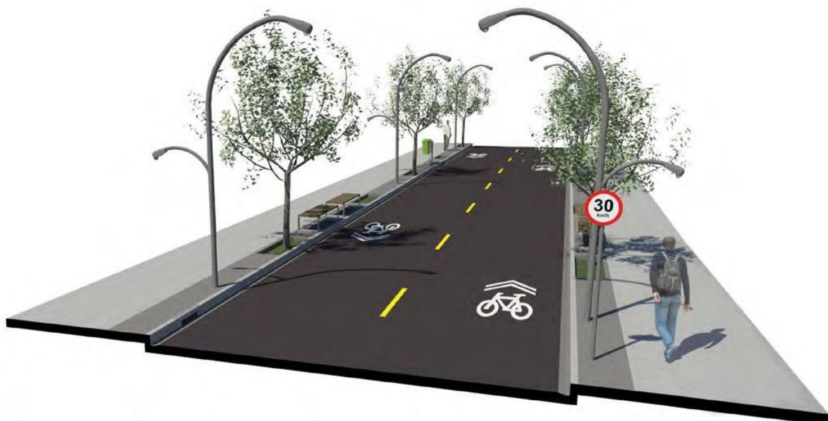
Figura 91 - Sinalização do tipo sharrow, indicada para ciclorrotas.
