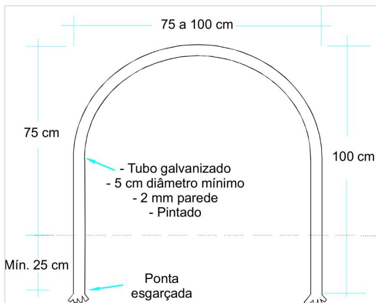
Figura 86: Modelo de paraciclo chumbado no pavimento.
