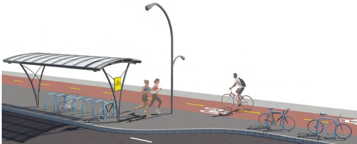
Figura 87 - Instalação de paraciclos em paralelo (esq.) e em linha (dir.).
