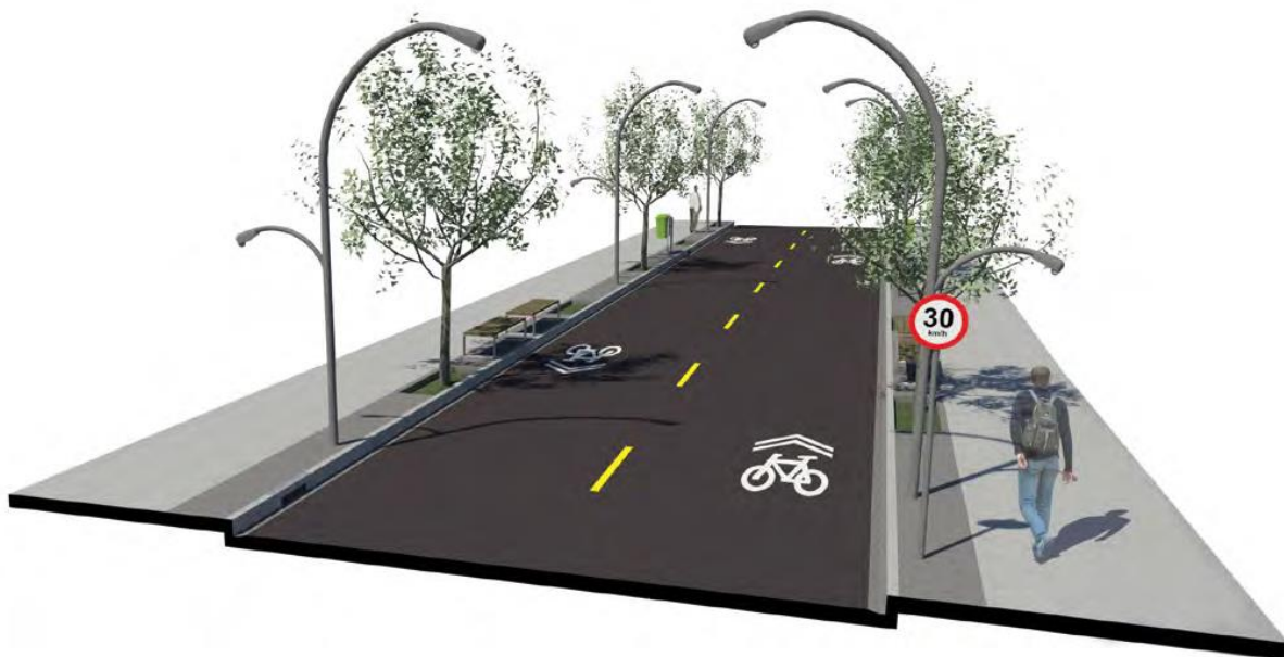
Figura 91 - Sinalização do tipo sharrow , indicada para ciclorrotas.
